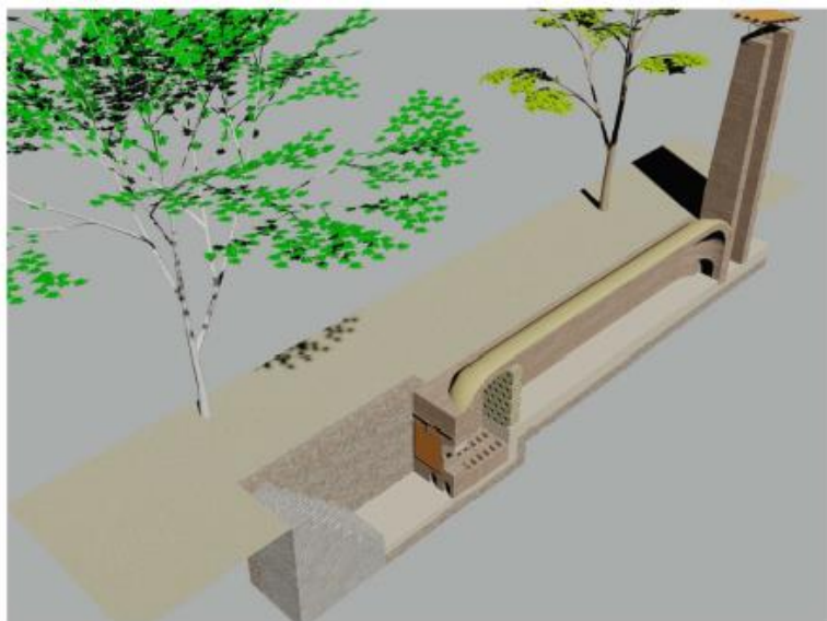
Coupe longitudinal du four
