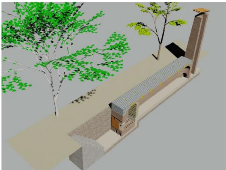
Coupe longitudinal du four transformée
